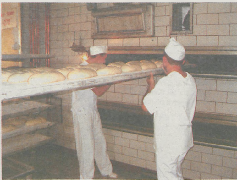
W PIEKARNI SĄ DWA PIECE - do jednego uformowane ciasto wkłada się na desce, a do drugiego na taśmie
