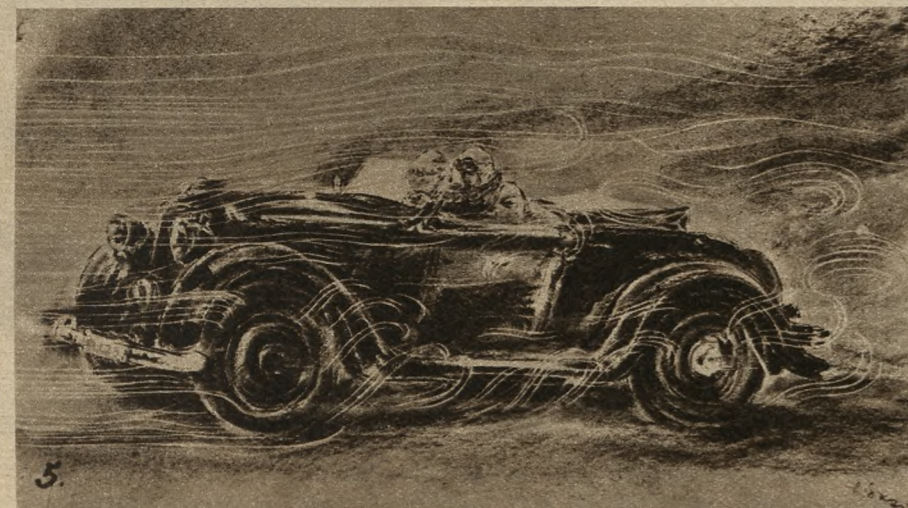
Rys. 5, 6, 7. Linie opływowe zmniejszają wiry powietrzne. Im bardziej opływowe kształty, tym mniejsze wiry. Na pierwszym obrazku widać pełno wirów powietrznych, tworzących się przy każdej nierówności przy wszystkich nie zaokrąglonych łagodnie miejscach samochodu. Na drugim widać jeszcze wiry już tylko przy nie osłoniętych kołach i siedzeniu kierowcy. Na trzecim cały samochód tworzy jedną idealną zaokrągloną całość, bo koła są także zastąpione, lekki wir tworzy się tylko w pobliżu sterującego.
