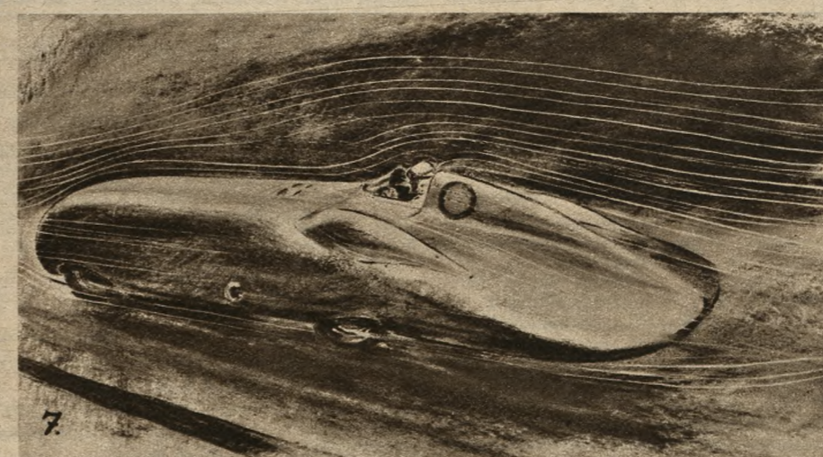
Rys. 5, 6, 7. Linie opływowe zmniejszają wiry powietrzne. Im bardziej opływowe kształty, tym mniejsze wiry. Na pierwszym obrazku widać pełno wirów powietrznych, tworzących się przy każdej nierówności przy wszystkich nie zaokrąglonych łagodnie miejscach samochodu. Na drugim widać jeszcze wiry już tylko przy nie osłoniętych kołach i siedzeniu kierowcy. Na trzecim cały samochód tworzy jedną idealną zaokrągloną całość, bo koła są także zastąpione, lekki wir tworzy się tylko w pobliżu sterującego.
